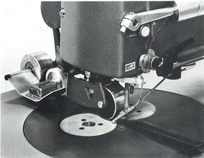
FW-Maschinenausschnitt mit Arbeitstisch, mit Diskusscheiben, Druckrolle, Fadenführer, Niederhalter, Meterzähler und Abreißrolle.
