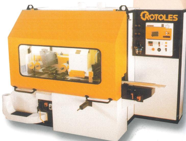
Zweiseitige kombinierte Kalibrierfräsmaschine mit Rotoles System und mit horizontaler Sägewelle unten.
