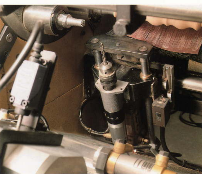
Gruppo di foratura trasversale Cross-drilling unit Groupe de perçage transversal Gruppe für Querbohrungen
