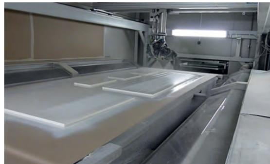
**Transportbänder:** Die Werkstücke werden ähnlich wie bei Durchlauflackieranlagen auf Transportbänder (z.B. Teflon, PVC), die auch als Papiertransport ausgeführt sein können, beschickt und beladen. Bei dieser Variante können die einzelnen Chargen frontal, längs, oder orthogonal von der Seite dem Spritzraum zugeführt bzw. entnommen werden.
