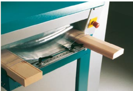
„Hobeln“ unterschiedlicher Profile in einem Durchgang
