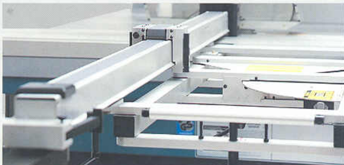
Die 4. Achse auf dem Parallelogrammtisch: Schneiden von Gehrungsmaßen gesteuert
