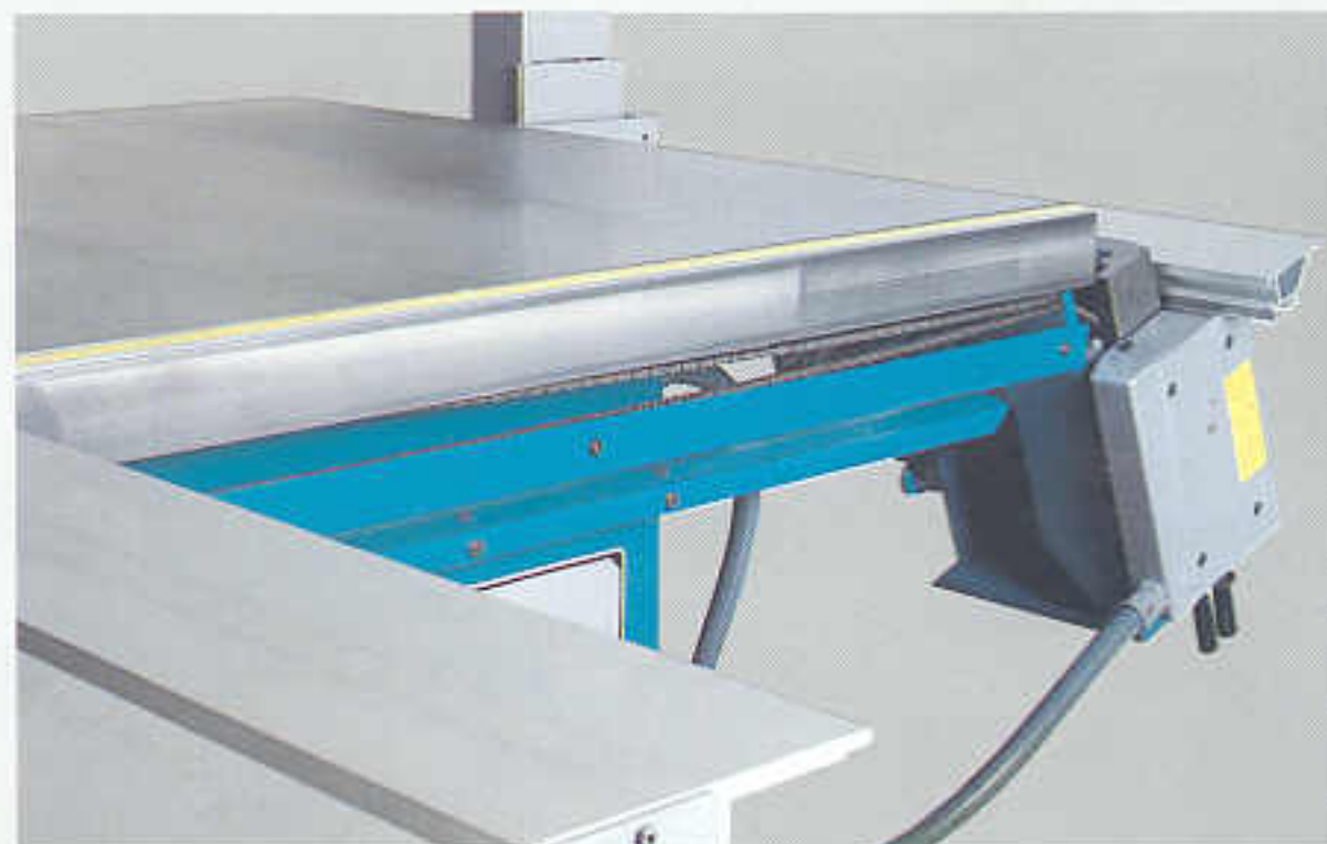
Das Kreissägegelineal ist unter den Tisch geklappt.
