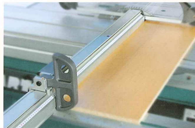
Analoger Längenanschlag mit durchgehender Anlage T 7337
