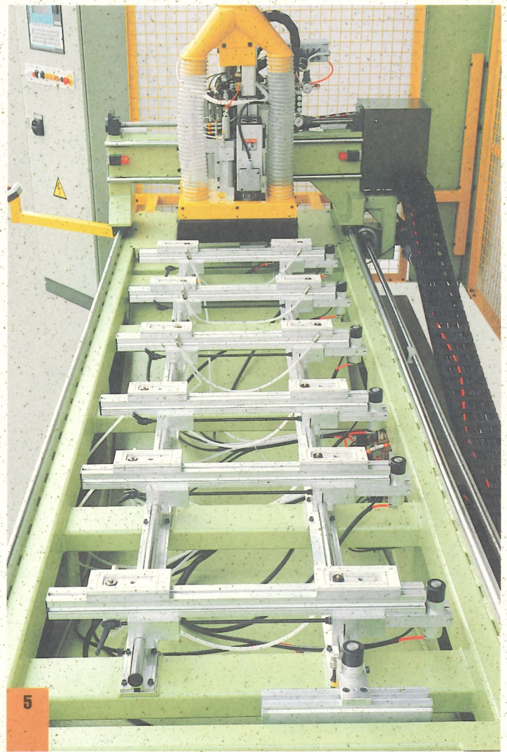
4 Gruppo fresatore per Speedy 315. Elettromandrino da 3 HP a 18.000 giri (opzionale 4,5 HP) con variatore di frequenza statico.
