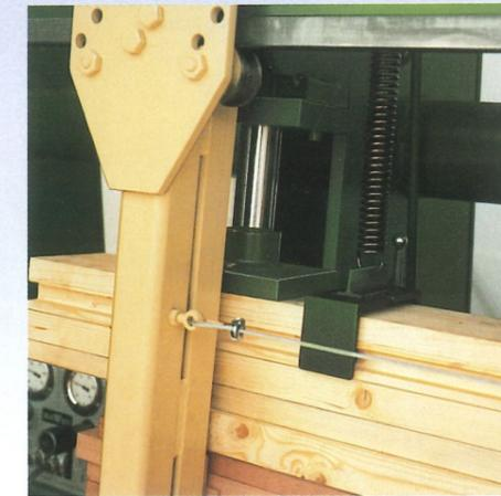
Abb. oben: Schwerer Preßzylinder, durch Druckübertragungsbalken garantiert dichte Leimfuge.
