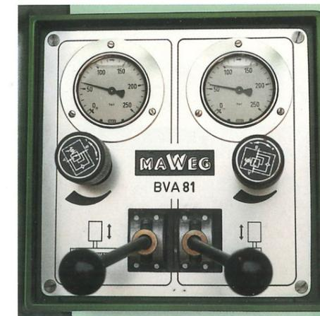
Abb.: Hydraulische Niederhaltung mit hohem Ausricht-Effekt, auch bei versetzter Profilverleimung.
