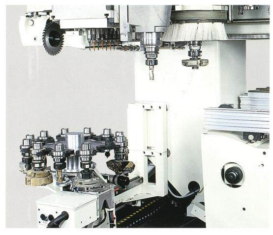
La Tool Room contiene fino a 12 utensili ed è abilitata a sostituirli su **entrambi i gruppi di fresatura** anteriori installati nella macchina.
