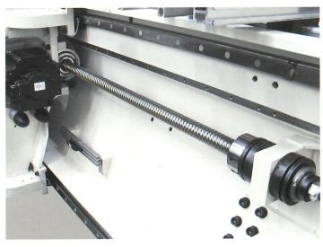
La movimentazione negli assi X, Y e Z avviene tramite motori Brushless su viti a ricircolo di sfere; in questo modo sono possibili **accelerazioni e decelerazioni fino a 5 m/sec²** e con assoluta precisione di posizionamento. Non richiede particolare manutenzione potendo essere lubrificata automaticamente senza interventi da parte dell'operatore.
