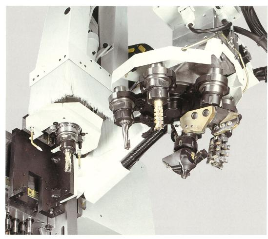
La velocità del cambio utensile Rapid 6, in grado di operare mentre la macchina sta effettuando altre lavorazioni, rende questa configurazione ideale per la produzione di pannelli in truciolare per cucine, armadi ecc.
