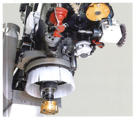
La velocità del cambio utensile, in grado di passare da un profilo ad un altro mentre la macchina esegue altre lavorazioni, rende questa configurazione ideale per i terzisti, produttori di porte, portoni, mensole a scomparsa, antine con differenti profili e sagomature.
