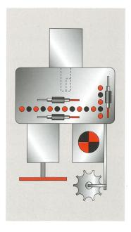
A) Gruppo fresa a disco con rotazione automatica 0/90° B) Elettromandrino 6,6 Kw con cambio utensile Rapid 6 C) Pantografo orizzontale D) Testa di foratura con 12 (18) mandrini verticali indipendenti e 6 mandrini orizzontali indipendenti.
