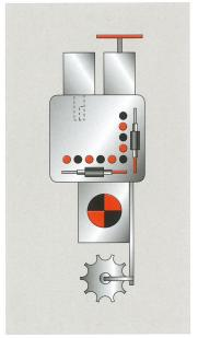
A) Elettromandrino 7,5 Kw con cambio utensili Rapid 10 B) Pantografo orizzontale C) Gruppo fresa a disco con rotazione automatica 0/90° D) Testa di foratura con 10 mandrini verticali indipendenti e 4 mandrini orizzontali indipendenti.
