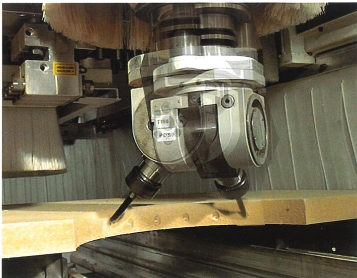
**VECTOR, asse rotante 0/360° gestito dal controllo numerico**, per eseguire fresature e forature trasversali e inclinate rispetto alle facce del pannello, utilizzando testine a rinvio angolare. Può effettuare senza problemi anche **fresature interpolanti**, grazie anche alla sua struttura con **movimento meccanico estremamente rigido e preciso**.
