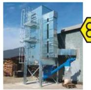
Beim NESTRO® Filterhaus können auf engstem Raum große Filterflächen untergebracht werden. Es ist zur Zwischenlagerung von Staub und Spänen geeignet und mit einem Rührwerk ausgestattet. Die Austragung kann über eine Schnecke (z.B. in eine Brikettierpresse) oder über eine Zellenradschleuse erfolgen.
