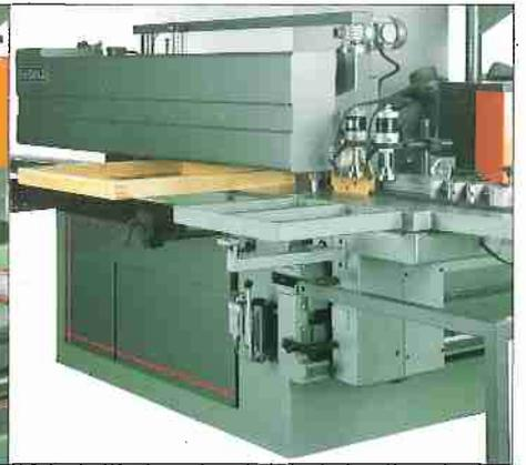
Umfahrung mit ausrichtbarer Vorrichtung auf der zu profilierenden Seite, mittels zeitlich gesteuerter Drehung der ersten Spindel rechts.
