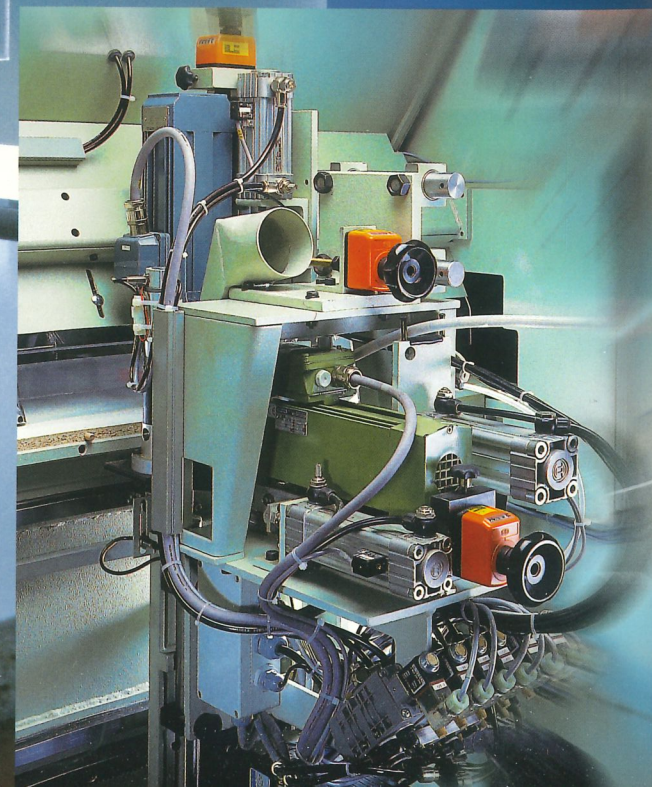
Stirnseitiges Bohren, Leimen und Dübeleintreiben plus flächenseitiges Bohren in einer Werkstückaufspannung
