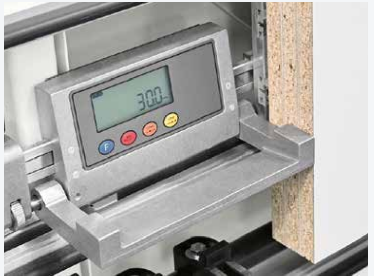
Digitale Maßanzeige für vertikale Schnitte
