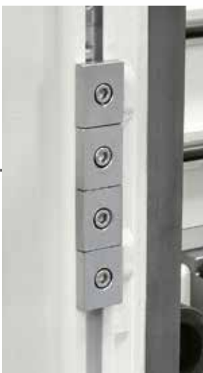
Programmiernocken für horizontale Schnitte (std. v, vs, vsi)
