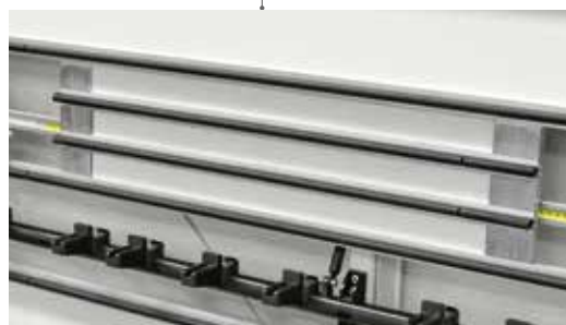
Schwenkbare Mittenaufgabe für kleine Werkstücke (Opt. v, vs, vsi)
