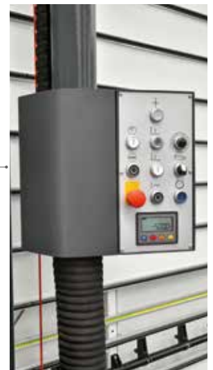
Digitale Maßanzeige für horizontale Schnitte (Opt. v, vs, vsi)
