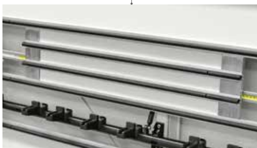
Verschiebbare Auflage für schmale Werkstücke (Opt. v, vs, vsi)
