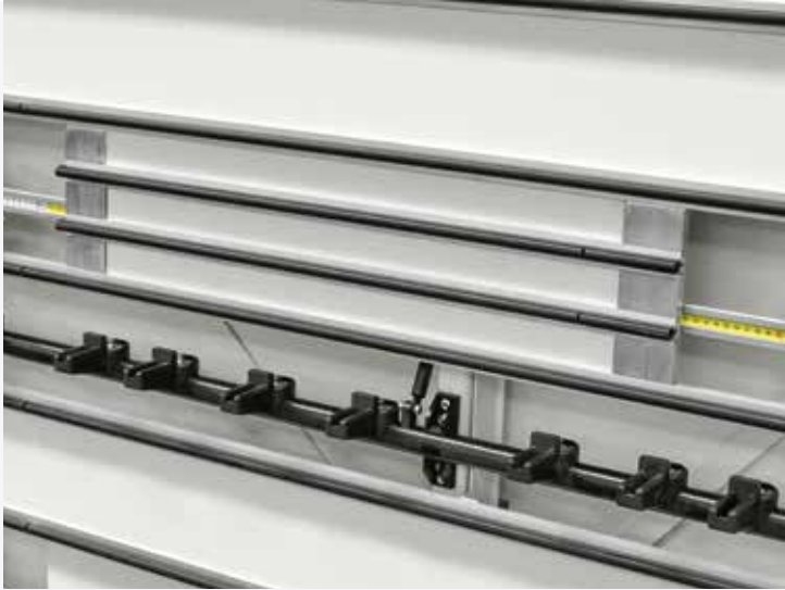
Verschiebbare Auflage für schmale Werkstücke
