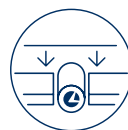
Unteren Werkstückauflagen aus Aluminium mit versenkbaren Transportrollen
