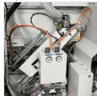
K/SEL Kappaggregat optimale Endbearbeitung dank Sägeblatt Schrägstellung.
