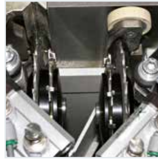
K-2 Radius Kappaggregat: Radiusfräsen in einer einzigen Operation.
