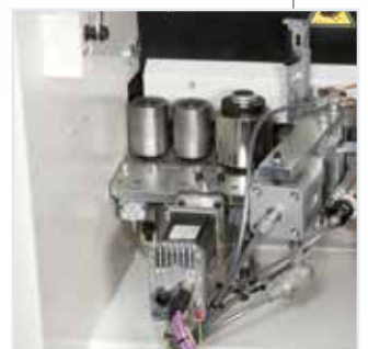
Positionierung der zeitgesteuerten Andruckrolle mit CNC Achsen.
