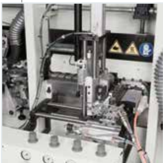
ROUND 1 Abrundaggregat: Endbearbeitung der Ecken auf geraden und profilierten Kanten.
