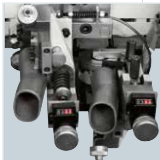
RAS/K Ziehklingenaggregat Eliminiert von den Kanten die eventuellen Bearbeitungsspuren der vorhergehenden Aggregate.
