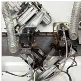
ROUND X Abrundaggregat mit 2 Motoren: Ausgezeichnete Plattenqualität mit gleichzeitigen Abrunden und Bündigfräsen.
