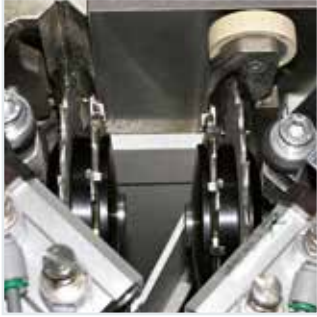
Kappaggregat K-2 RADIUS: Radiusfräsen in einer einzigen Operation.
