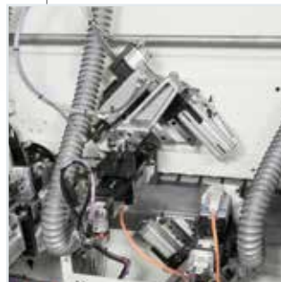
ROUND X-MULTIEDGE Abrundaggregat mit 2 Motoren CNC Achsen für automatisches Einstellen.
