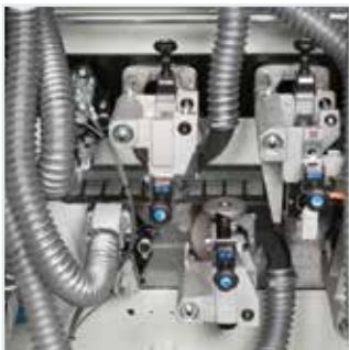
RAS-V Ziehklingenaggregat perfekte Endbearbeitung von Radiuskanten aus PVC/ABS.
