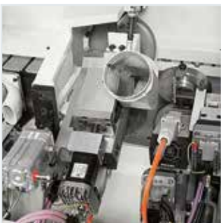
R-HP Multiedge 2R Bündigfräsaggregat.
