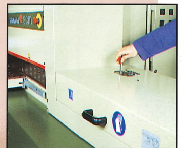
Scoring unit set up from outside of the machine. Vorritzaggregat von ausserhalb der Maschine einstellbar.
