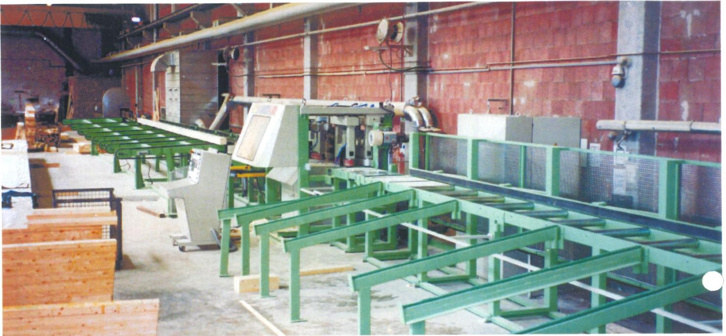
Die SCHMIDLER S2 ist eine hochrationelle Zuschnittanlage im Längsdurchlaufverfahren. Sie ist mit einem patentierten Transport- und Meßsystem ausgestattet, das durch seine enorme Leistungsfähigkeit und Fertigungsbreite neue Maßstäbe setzt - vom Nagelbinder bis zum Leimholz - SCHMIDLER S2
