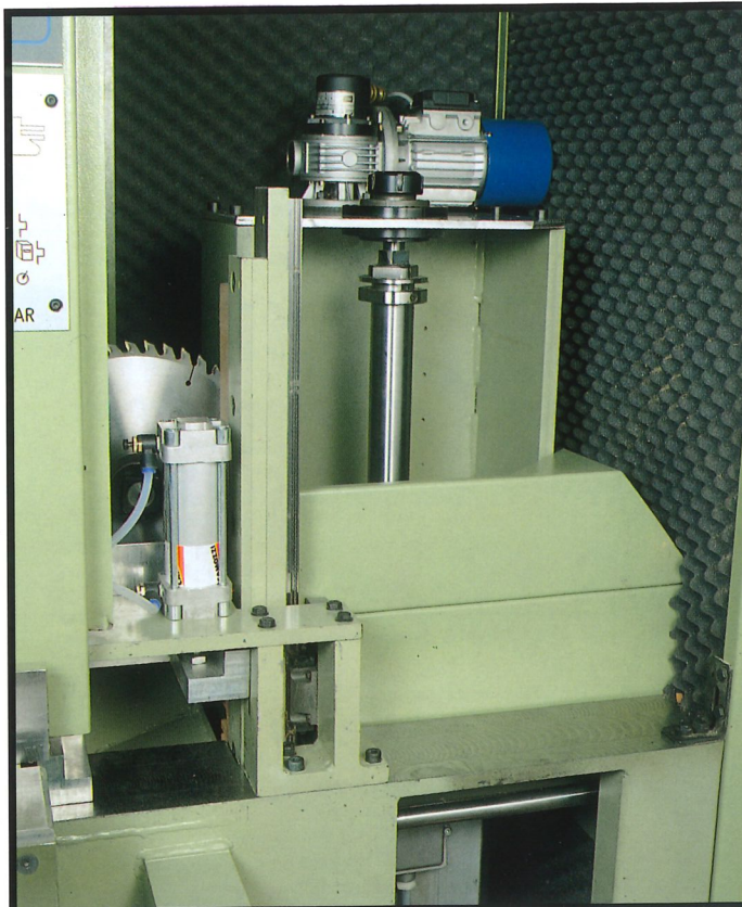
Albero tenonatore multifrese Multi-tool tenoning spindle Arbre tenonneur à fraises multiples Eje espigador multi-fresas
