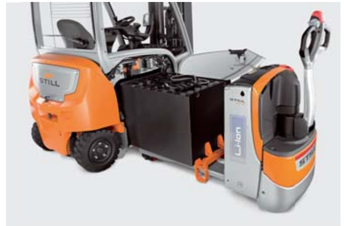
Sicherer und leichter Batteriewechsel mit Elektrohubwagen.
