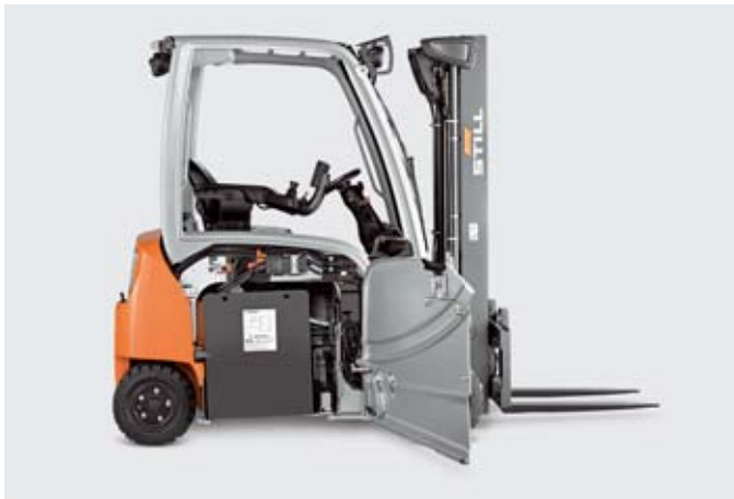
Schneller, seitlicher Batteriezugang ermöglicht maximale Verfügbarkeit.
