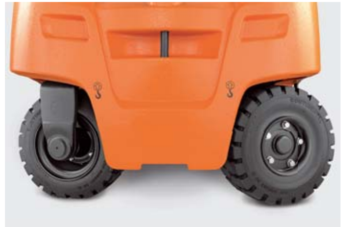
Die beiden Reifen sind um 90 Grad nach links und rechts drehbar.
