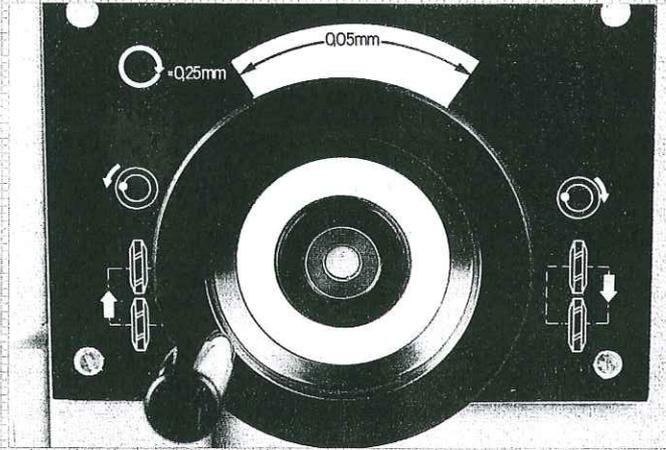
Vertikale Feineinstellung der Fräswerkzeuge mit 1/10 mm Genauigkeit
