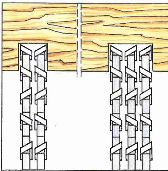
Die Sägeblätter, die die Ausplattung vornehmen, sind durch Zwischenringe auf die Abmessungen des Profilfrässers einstellbar.
