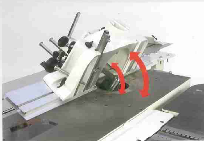
La coiffe peut être enlevée et repositionnée sans perdre la position d'usinage.
