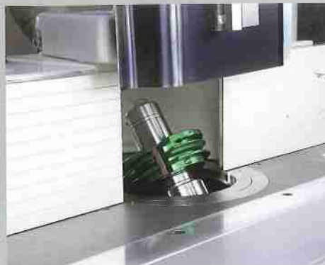
L'arbre toupie inclinable de 45 degrés vers l'intérieur de la machine est disponible sur demande.
