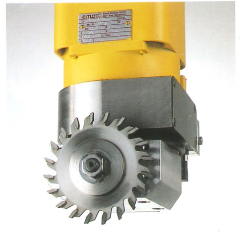
Schwenkbare Nuf- und Formatiersäge (90 Grad)
