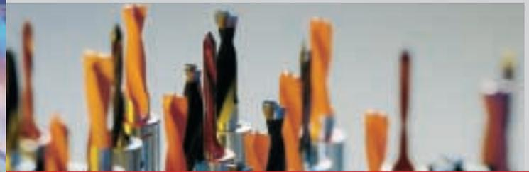
Das Bohraggregat der BST 100 umfasst bis zu 40 einzelne Bohrer.
