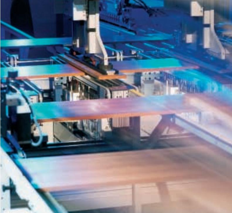
Die komplexeren Bohrabläufe der Z-Achse werden für jeden Bohrkopf in eigenen NC I Kanälen durchgeführt.
