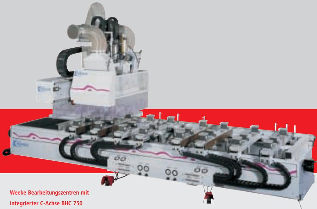
Weeke Bearbeitungszentren mit integrierter C-Achse BHC 750
