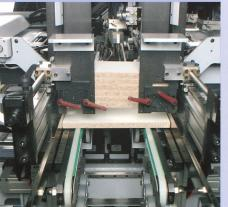
**Option: Longitudinal edge drilling**
