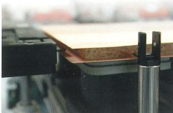
Gewährleistet einfaches Positionieren bei Material mit Furnierüberstand
