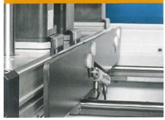
4 robuste Einlegehilfen zum Belegen schwerer Werkstücke
