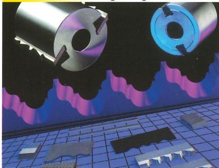
n'est exposée ni à la sciure ni à la résine. C'est pourquoi elle est facilement accessible. C'est pourquoi elle peut être dévissée et nettoyée sans problèmes. La rainure du fer est usinée de façon extrêmement précise. Le fer est logé dans une denture. De ce fait il a une assise parfaite. Il est tenu par un coin de serrage qui s'élargit de 25° vers l'intérieur. De cette façon, la pression de serrage exercée sur le fer augmente en fonction de la vitesse de rotation du porte-outils.
