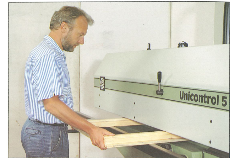
Umfräsen der Fensterflügel – präzise und ohne Ausrisse.
