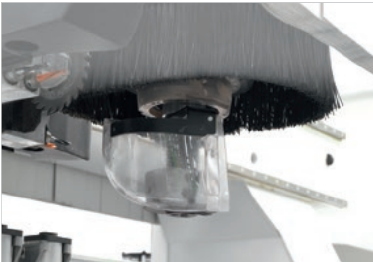
CNC-gesteuertes Späneleitsystem (Späneleitblech).
