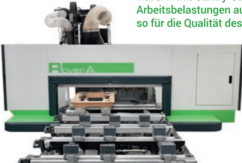
Uniclamp-Spannvorrichtung mit pneumatischer Schnellentriegelung.
