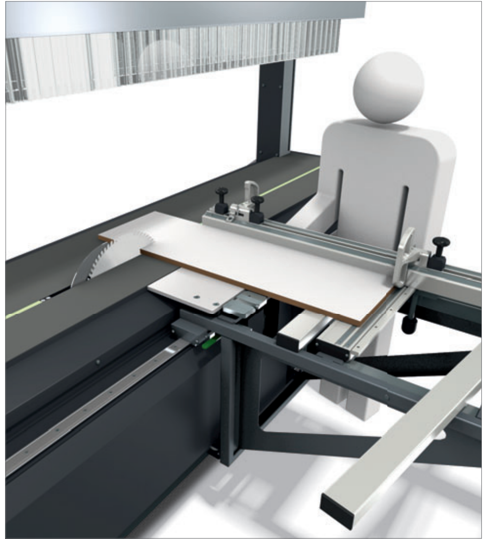
_ Ablängen kurzer, schmaler Streifen mit fixiertem Sägeaggregat
