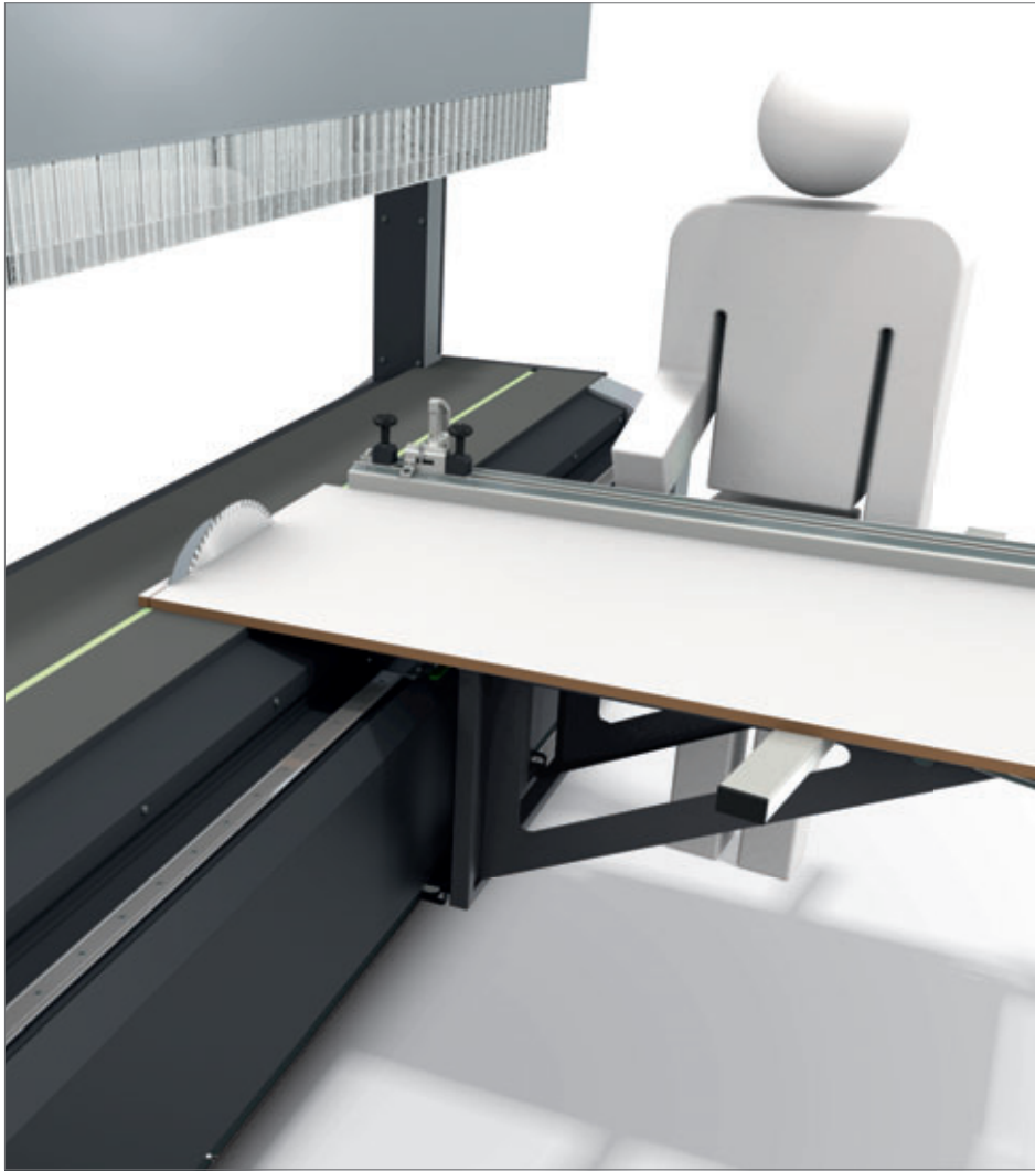
_ Formatieren mit fixiertem Sägeaggregat
