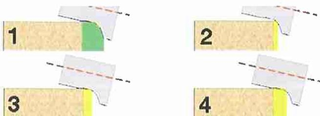
Système FAST à 2 ou 4 positions pour changement de placage (ex. 0,4 / 2 mm et viceversa) par CNO.
