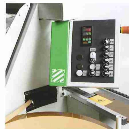
Système de contrôle à relé avec tableau de commande orientable en position ergonomique.
