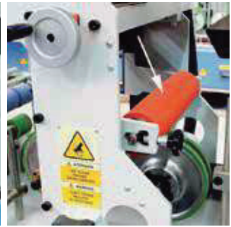
Adjustable first moulding roller. Primer rodillo moldeador ajustable en altura. (PUR)
