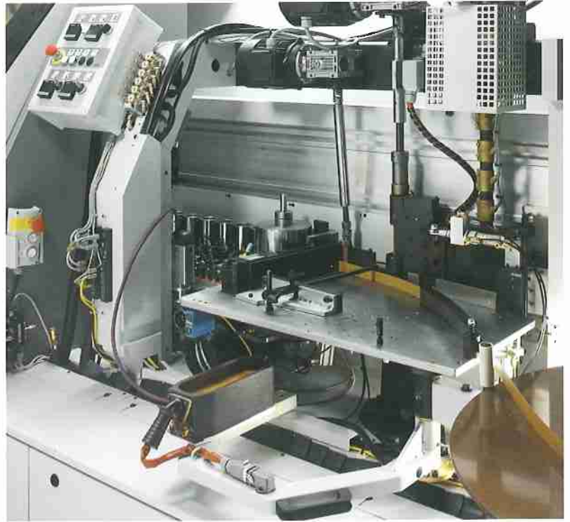
Systeme breveté High-Melt avec extraction frontale du bac colle.
