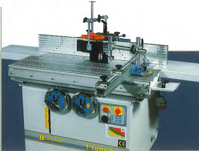
T 1000 S mit hart eloxiertem Aluminium-Zapf- und Schlitzschiebetisch, Teleskopanschlag und Tischverlängerung für die Bearbeitung von großen Werkstücken.
