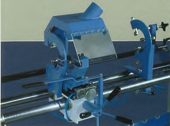
CL 1200 mit angebaute Kopiervorrichtung, kopieren vom Originalteil oder nach Schablone möglich.
