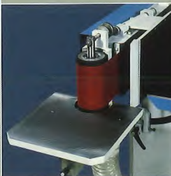
Höhenverstellbarer Radienschleiftisch mit Absaugung und Schleifwalze mit Gummibelag zum Schleifen von Radien.
