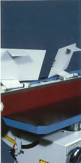
Schleifanschläge aufgeklappt und arretiert.
