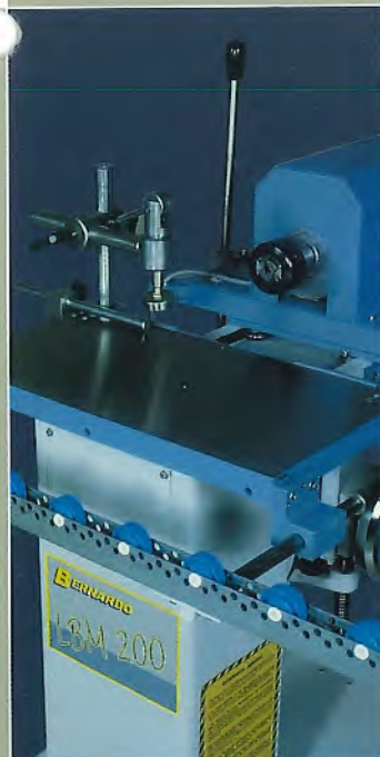
Ausziehbare Tischverbreiterung für große Werkstücke.
