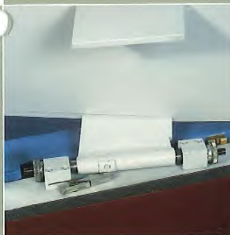
Schleifanschlag mit Feineinstellung und Selbstarretierung.
