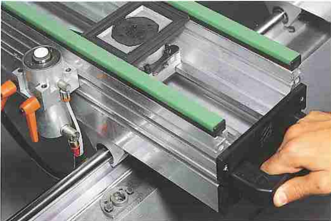
5A/B: Sistema di bloccaggio dei piani di lavoro con battute centrali Système de blocage des plans de travail avec butées centrales
