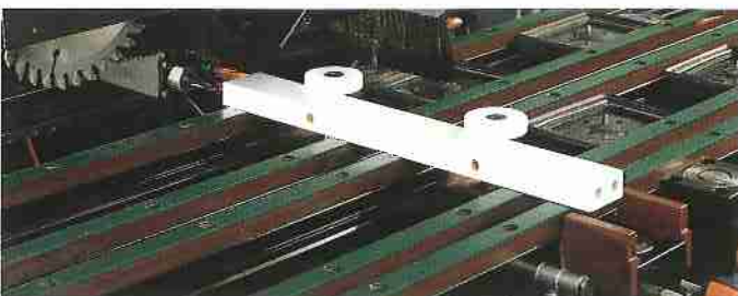
5E: Dispositivo per il bloccaggio di pezzi stretti tramite strettoli pneumatici Dispositif pour le blocage de pièces étroites au moyen de presseurs pneumatiques
