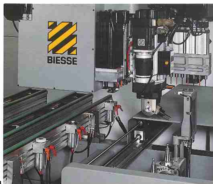
19B: Versione con magazzino collocato a destra per 3 utensili speciali utilizzabili con l'asse "c" Machine avec magasin monté à droite pour le changement automatique de 3 outils spéciaux utilisables avec l'axe "c"
