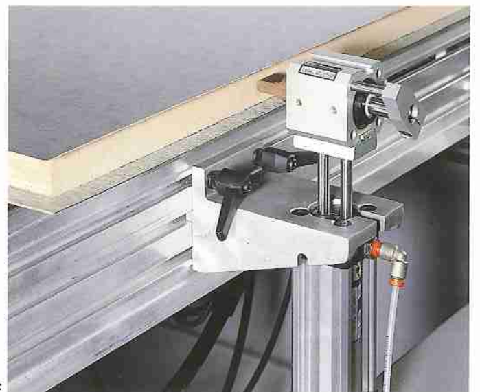
5F: Battute speciali a due movimenti per pannelli con bordi sporgenti Butées spéciales à deux mouvements pour panneaux aux bords saillants
