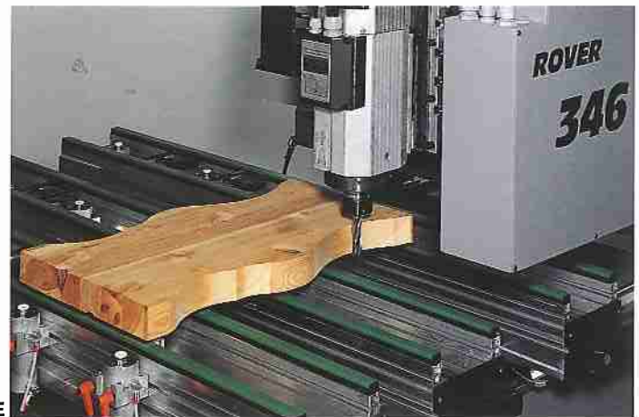
7E: Fresatura eseguita con l'ausilio di controgabariti Défonçage réalisé à l'aide de contre-gabarits
