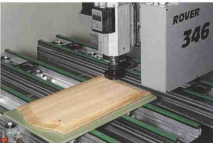
7D: Fresatura eseguita con sistema di depressione ausiliario Défonçage réalisé à l'aide du système à dépression auxiliaire
