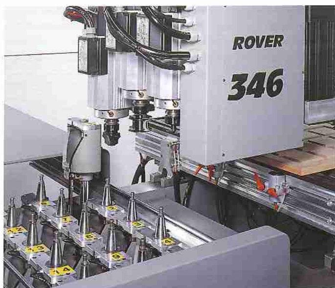
19A: Versione con magazzino collocato a sinistra per 15 utensili Machine avec magasin monté à gauche pour le changement automatique de 15 outils
