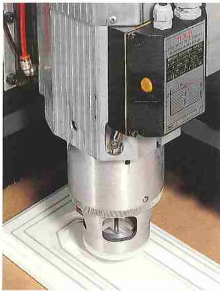
7B: Unità a fresare con copiatore meccanico lungo l'asse Z Tête de défonçage avec palpeur sensible mécanique selon Z
