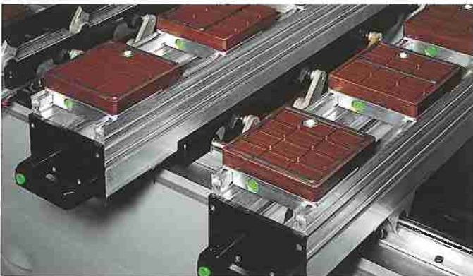
5C: Controsagome universali a bloccaggio pneumatico per pannelli di diverse dimensioni Contre-gabarits universels avec blocage pneumatique pour panneaux de différentes dimensions
