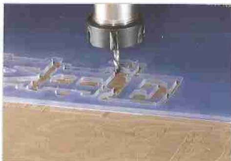
Lavorazione di lastre in materiale plastico
