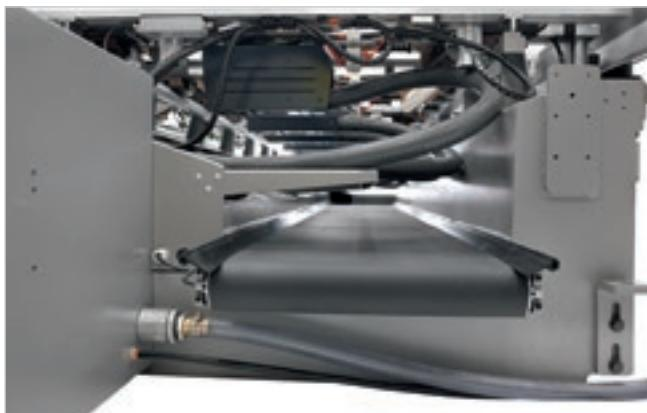
Ленточный транспортёр с электроприводом для удаления стружки и обрезков.
