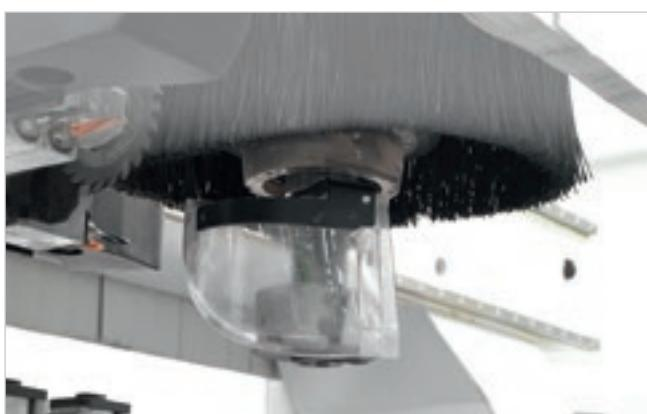
Дефлектор стружки, управляемый ЧПУ
