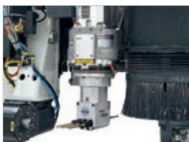
Многофункциональная группа, непрерывно позиционируемая на 360° под управлением ЧПУ, может принимать агрегаты для исполнения специфических обработок (вырезы под замок, посадочные места под петли, глубокое горизонтальное сверление, торцевание и т. п.).
