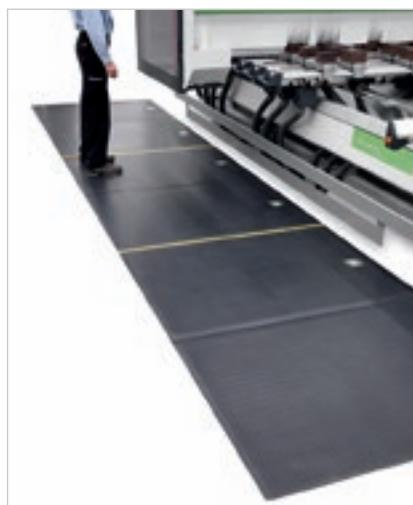
Чувствительные коврики позволяют станку постоянно работать с максимальной скоростью
