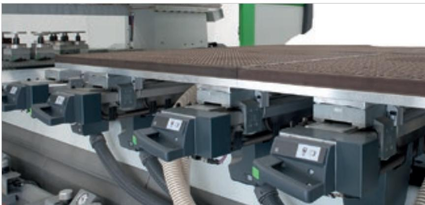
Те же функции и качество, что и у настоящего пантографа, обеспечиваются рабочим столом CFT (Convertible Flat Table, то есть трансформируемый плоский стол); это позволяет производить обработку тонких панелей, а также типа «нестинг» и «фолдинг» на станке с балочными рабочими столами.
