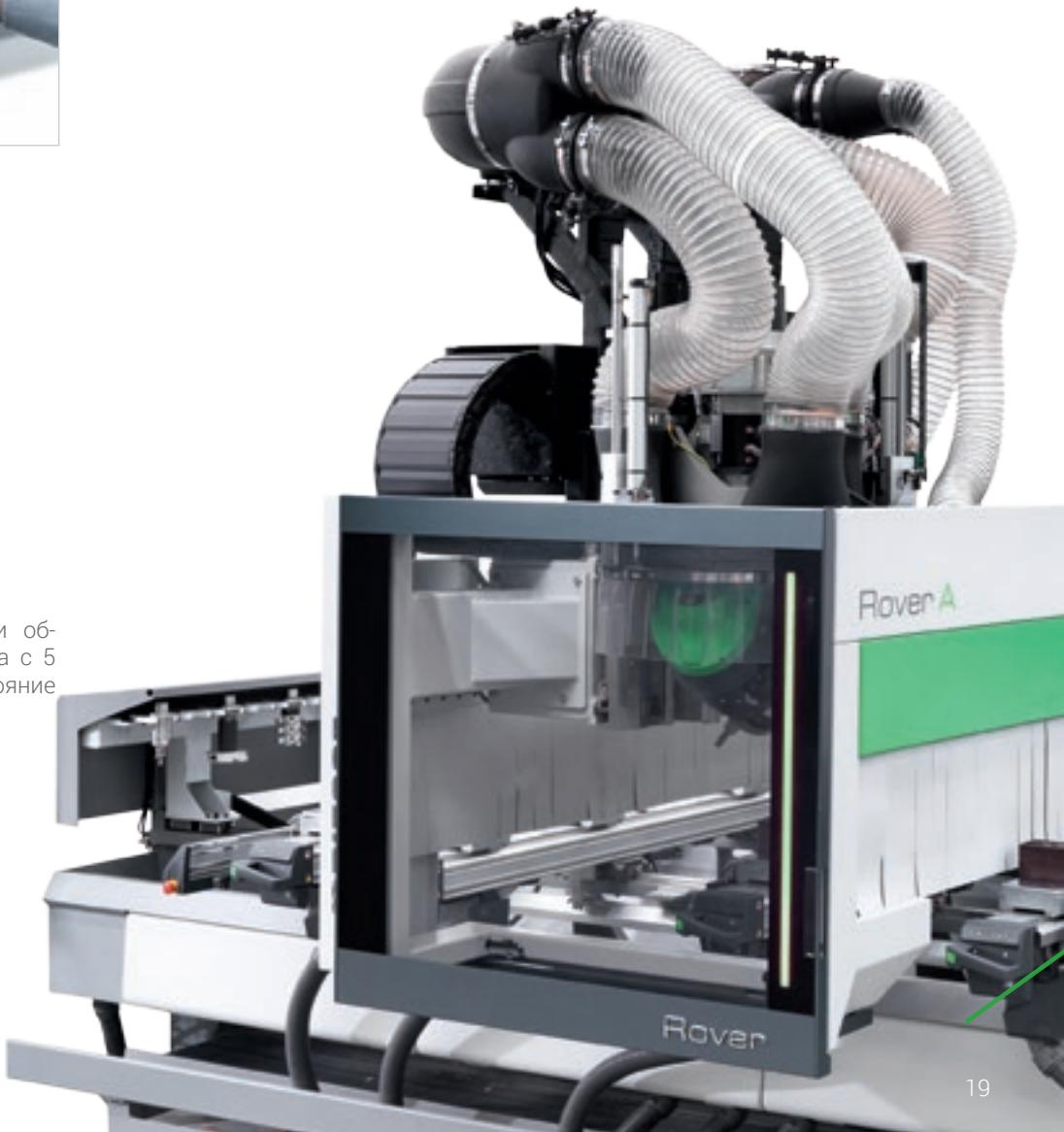
Максимальная видимость при обработке. Светодиодная полоса с 5 цветами, показывающая состояние станка в реальном времени.
