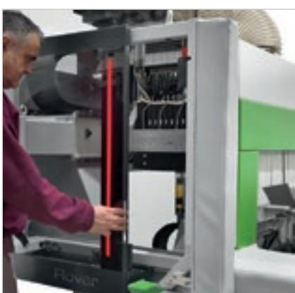
Лёгкий доступ при операциях оснащения благодаря открываемой передней обшивке.
