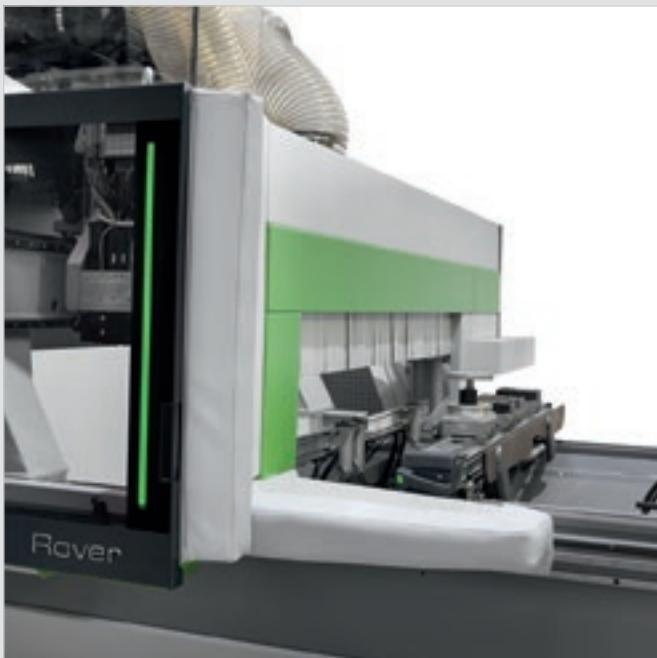
**Безопасность и гибкость благодаря новым бамперам в сочетании с фотоэлементами, не занимающими места на полу, при работе в динамическом маятниковом режиме.**
