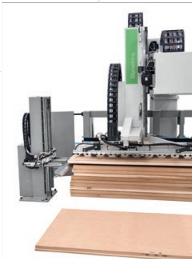
Устройство для отбора пористых панелей или панелей с деликатным покрытием
