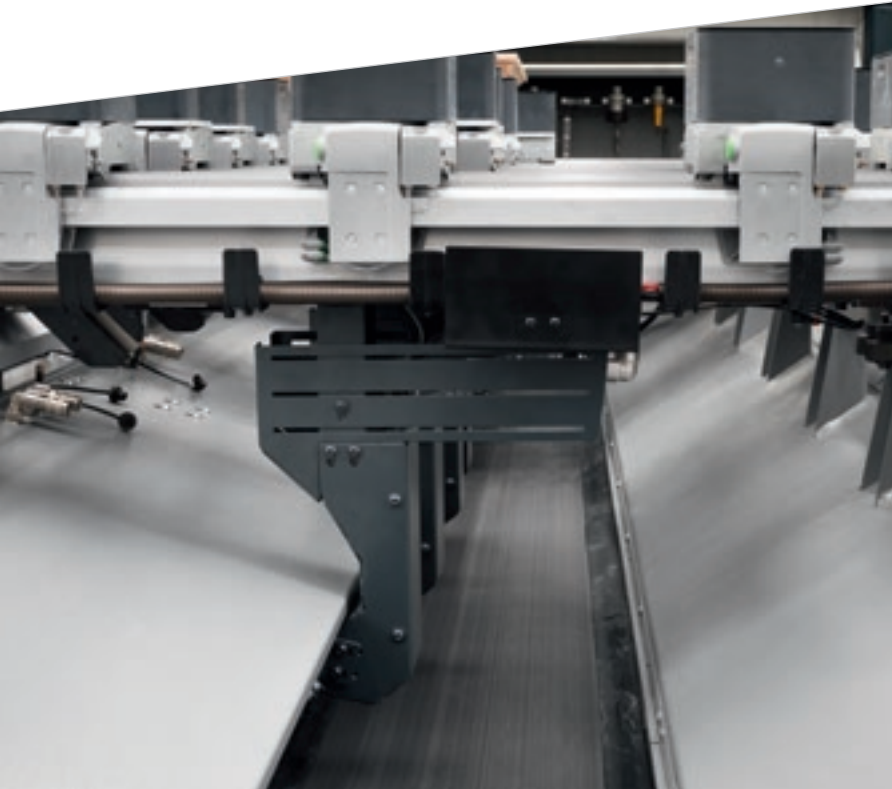
Motorisiertes Förderband zum Abtransport von Spänen und Bearbeitungsabfällen.
