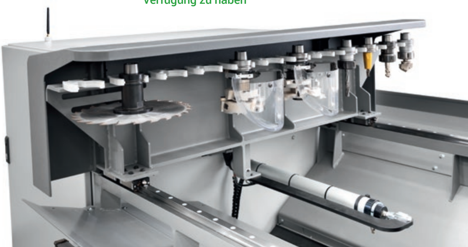
Gestell-Werkzeugmagazin 12\23 Plätze mit integriertem Pickup.
