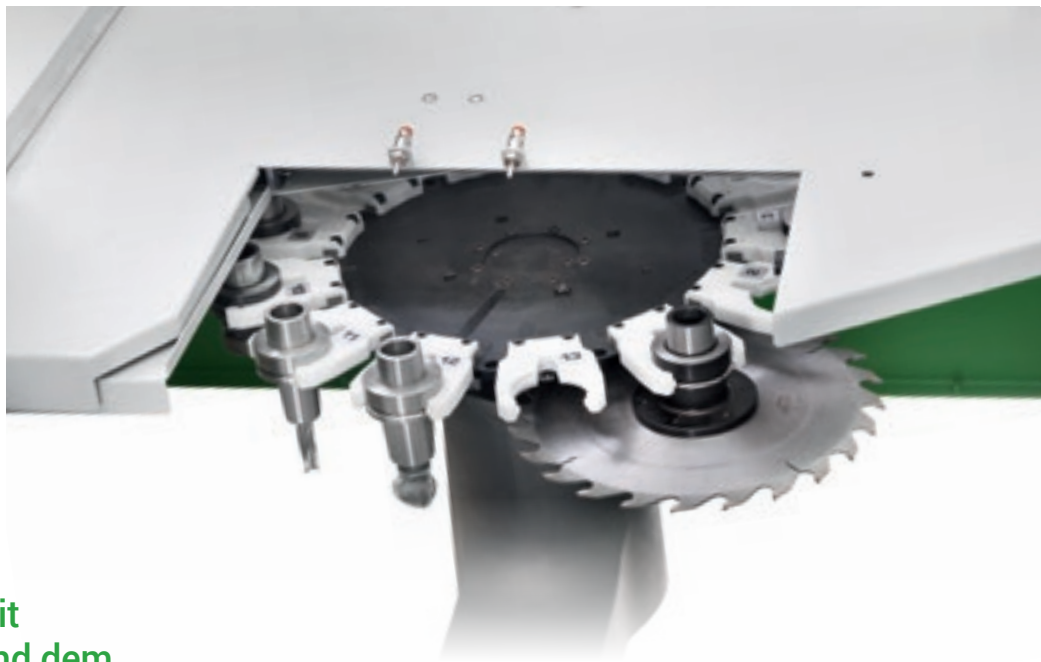
Gestell-Werkzeugmagazin 12\23 Plätze mit integriertem Pickup.
