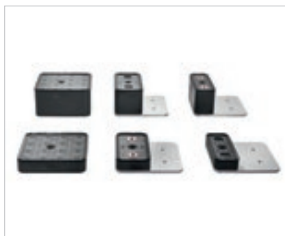
Modules pour le système de blocage par le vide. Contre-gabarits dotés de caoutchoucs pour augmenter la résistance en présence de poussées horizontales causées par le placage.
