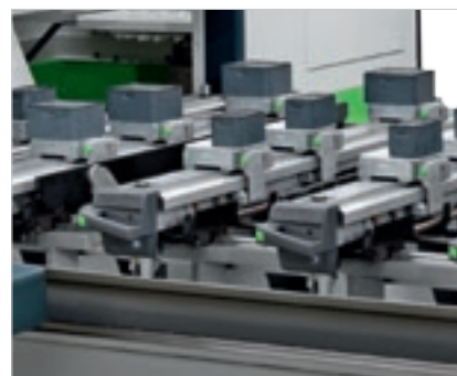
ATS (Advanced Table-Setting System) ti permette di posizionare in modo manuale l'intera area di lavoro.
