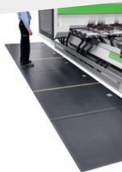
Las **plataformas sensibles** permiten que la máquina trabaje a una velocidad máxima constante.
