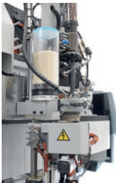
El sistema de alimentación de gránulos, solidario al grupo de encolado, carga la cola mientras la máquina está realizando otras operaciones. Al conservar la cola en gránulos, fusionando solamente la cantidad necesaria para la operación que se está realizando, se mantienen íntegras todas sus características de encolado para garantizar las máximas prestaciones.
