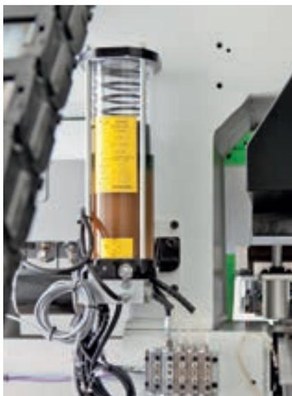
**Автоматическая смазка** - это опция, которая обеспечивает непрерывную смазку основных систем перемещения станка без необходимости вмешательства оператора.
