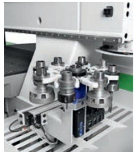
Гребенчатый магазин на 13-16 позиций предоставляет в распоряжение пользователя простое и функциональное решение с компактными размерами.
