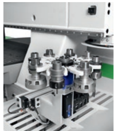
Revolverwechsler mit 8 Plätzen, fest mit dem Querträger der Maschine verbunden.
