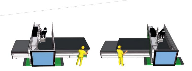
Il est possible de configurer la machine avec la fonction pendulaire pour pouvoir façonner les panneaux sur les origines opposées de manière alternée et effectuer ainsi les opérations de chargement et de déchargement en temps masqué.
