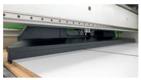
Le Sweeper Arm, à aspiration intégrée, permet d'effectuer simultanément le déchargement des pièces et le nettoyage de la pièce de tête, en évitant l'intervention manuelle et en augmentant ainsi la productivité.
