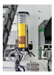
La lubrification automatique garantit une lubrification continue des principaux organes d'actionnement de la machine sans l'intervention de l'opérateur.
