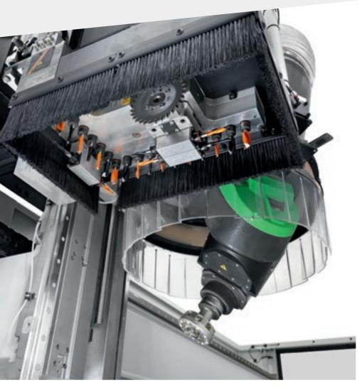
Rover A SMART FT est équipé des mêmes composants que ceux utilisés sur les autres modèles haut de gamme. L'électrobroche, la tête de perçage et les agrégats sont conçus et réalisés pour Biesse par HSD, entreprise leader dans son secteur à l'échelle mondiale.
