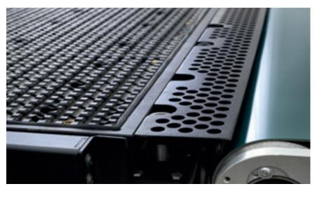
Le système d'aspiration des copeaux placé entre la machine et le tapis de déchargement garantit la plus grande propreté des pièces.
