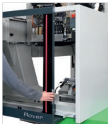
Полная защита рабочей головы. Широкий открывающийся люк обеспечивает максимальную видимость обработки и лёгкость доступа к рабочим группам.
