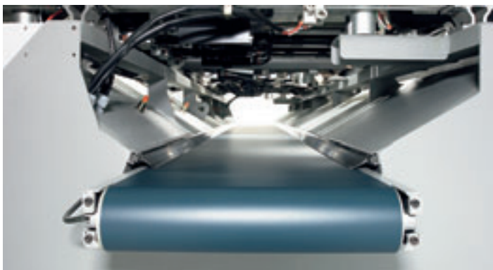
Tappeti motorizzati per la rimozione di trucioli e sfridi.
