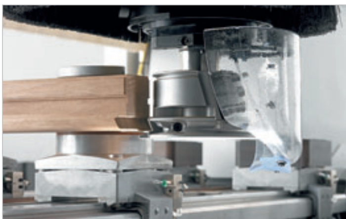
Convogliatore di trucioli gestito da controllo numerico.
