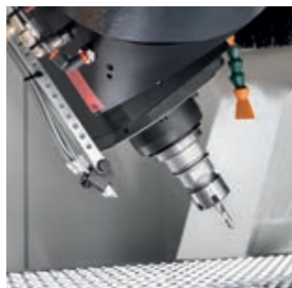
Sistema Air Jet que refrigera la herramienta con aire a -14 °C y permite que nunca se recaliente la herramienta ni se empaste el material.
