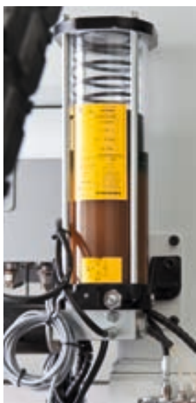
La lubricación automática es una opción que garantiza la lubricación continua de los principales mecanismos de movimiento de la máquina sin necesidad de que intervenga el operario.
