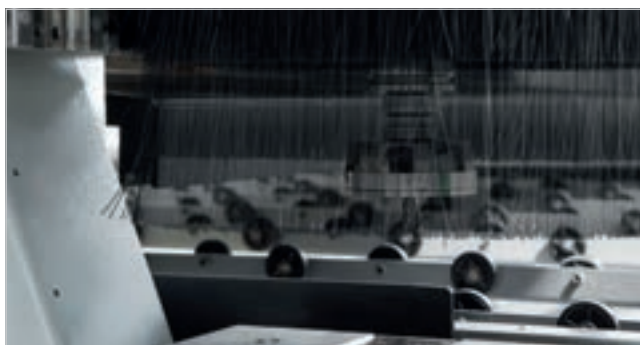
Campana de aspiración con 6 posiciones de regulación en altura.
