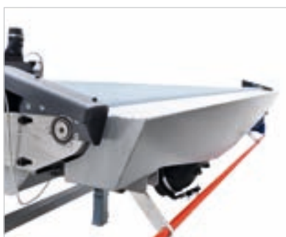
Kit adicional de aspiración para la cinta de descarga, compuesto por 2 campanas de aspiración, una situada en la parte superior de la cinta de descarga y la otra situada al final de la misma.
