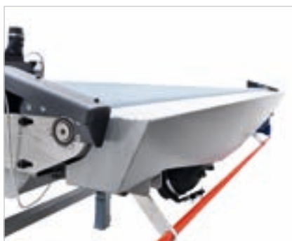
Système de chargement des panneaux par élévateur à ciseaux et alignement automatique du panneau. La simplicité du système garantit une grande fiabilité dans le temps.
