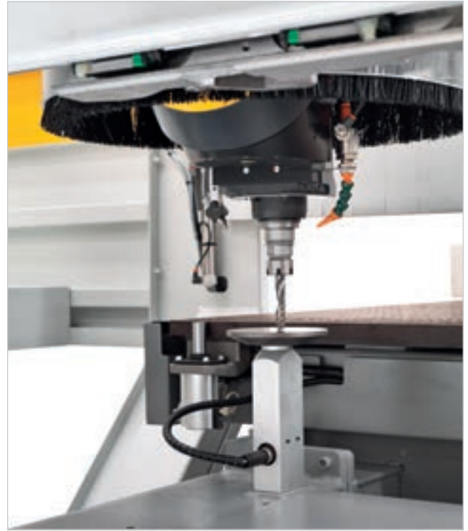
Réduction des temps d'outillage machine sans erreurs de la part de l'opérateur grâce au Présélecteur à contact qui permet de mesurer automatiquement la longueur de l'outil.
