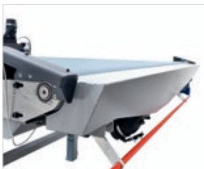
System ładowania płyt za pomocą podnośnika nożycowego i automatyczne wyrównywanie płyty. Prostota systemu gwarantuje niezawodność w czasie.
